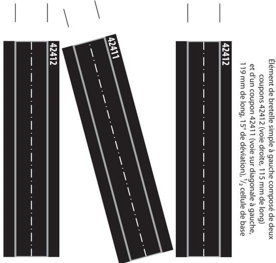
Élément de bretelle simple à gauche composé de deux coupons 42412 (voie droite, 115 mm de long) et d'un coupon 42411 (voie sur diagonale à gauche, 119 mm de long, 15° de déviation), 1/2 cellule de base
