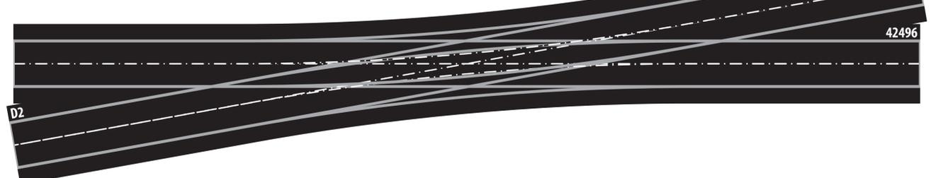
42454 : Aiguille triple asymétrique de moyen rayon, 287,5 mm de long, 873,5 mm de rayon, 15° de déviation
